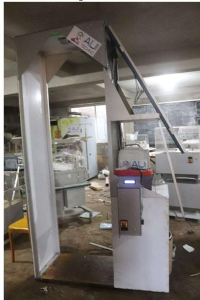
Ce modèle, que nous venons de développer, est encore a ca version beta. Il remplit déjà toutes les fonctions d'un portique de désinfection ordinaire, c'est-à-dire effectivement désinfecter le corps, les mains et les chaussures. En plus de cela, le système est entièrement automatique et donc est facile d'utilisation. On retrouve les matériaux localement (partie mécanique) et facilement a l'étranger (partie automatisme ou électronique).
